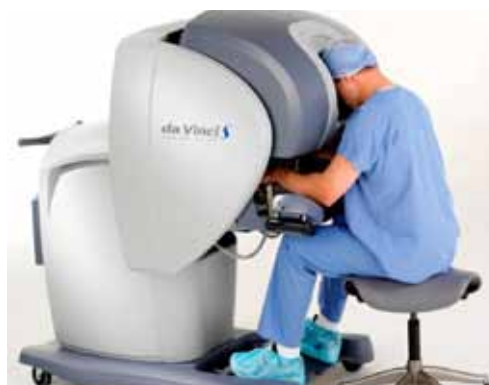
Figure 6-7. Les mouvements réalisés par le chirurgien à la console de commande du robot sont miniaturisés et reproduits avec une précision extrême par les instruments chirurgicaux dans l'abdomen du patient
