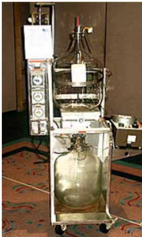
Machine de DP automatisée mise au point par Fred Boen (à noter le réservoir de 40L)
