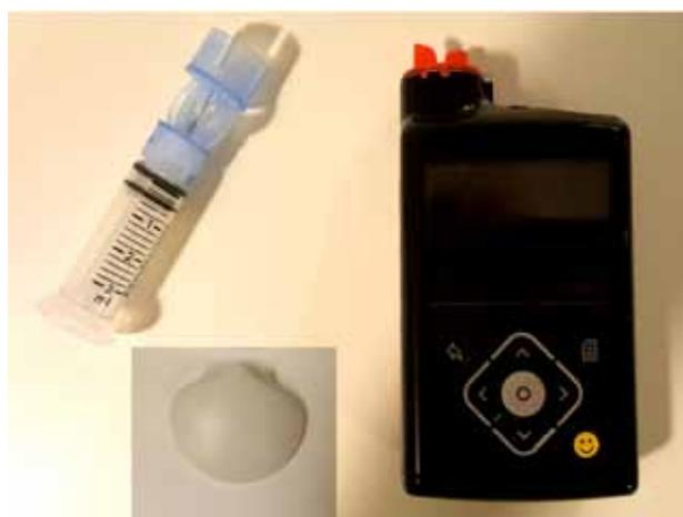
Photographie d'une pompe interrompant l'infusion d'insuline avant l'hypoglycémie. Sa taille n'excède pas celle d'un lecteur MP3. A sa gauche, le réservoir d'insuline et en dessous, le capteur de glucose interstitiel.
